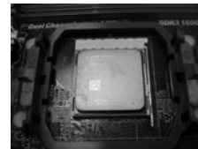
步驟 4： 下推並鎖住插座拉桿
